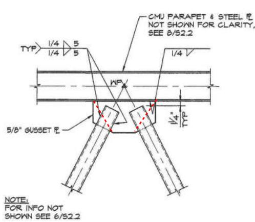
X-BRACE CONNECTION CAPACITY FOR PIPE BRACE
